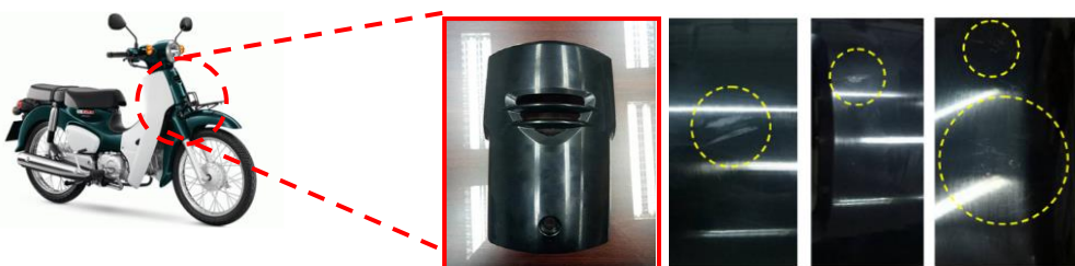
รูปที่ 1 ชิ้นงาน PHD 406 หรือ COVER FR และบริเวณที่พบปัญหาลึกลึลาย
